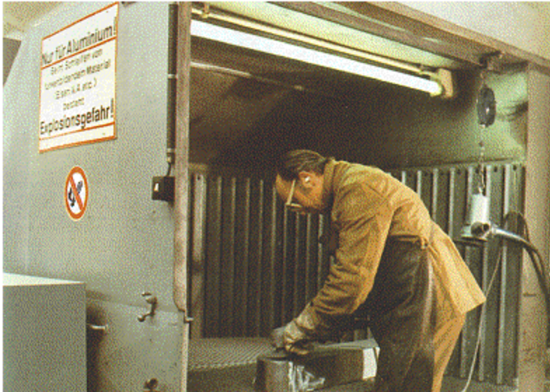
Bild 28: Beim Schleifen von Aluminium, Magnesium und ihren Legierungen bestehen besondere Gefahren
