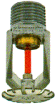
Bild 74: Sprinkler, Kennfarbe rot, Auslösetemperatur 68 °C
