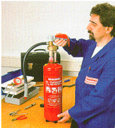
Bild 70: Öffnen eines Pulver-Aufladelöschers
