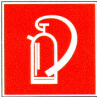
Bild 57: Hinweiszeichen auf Feuerlöschgeräte
